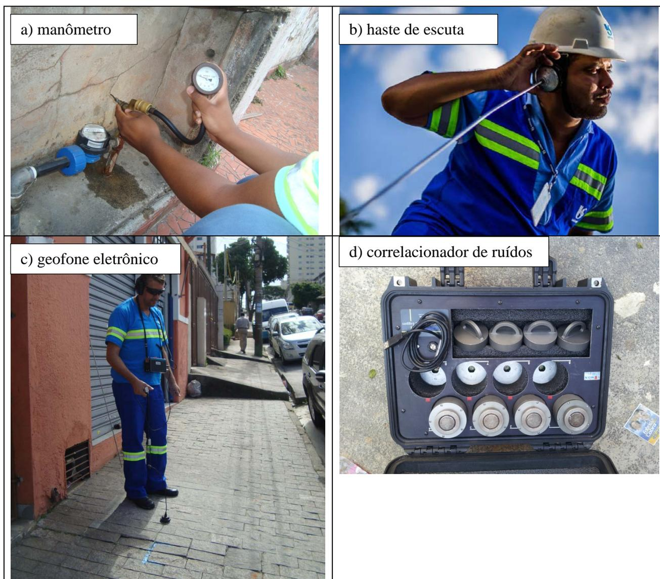
**Figura 7. Equipamentos utilizados no trabalho de detecção de vazamentos não visíveis.**
